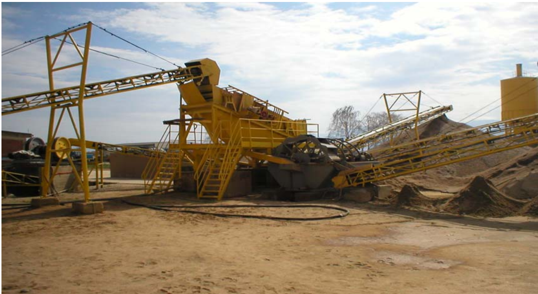
Слика бр.4 Втората транспортна лента, систем од сита и четири транспортни ленти за четирите фракции со различна гранулација
