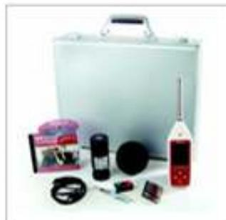
Слика бр. 2: Инструмент за мерење на бучава
