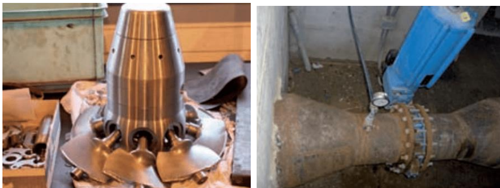
Слика 22. Капланова микро турбина со осум лопатки и регулационен вентил
