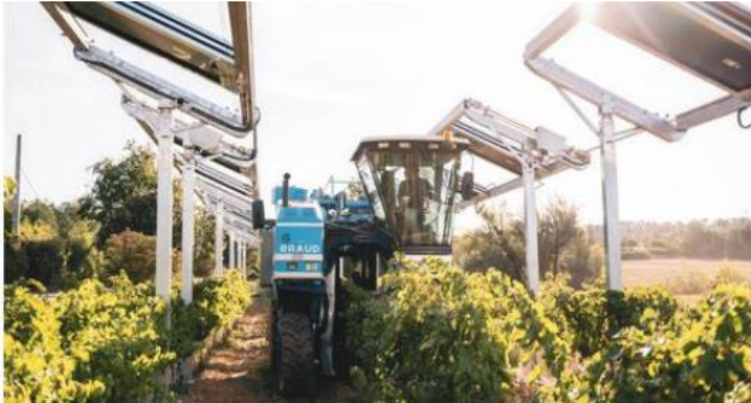
Слика 28. Мобилни фотоволтаични панели 37
