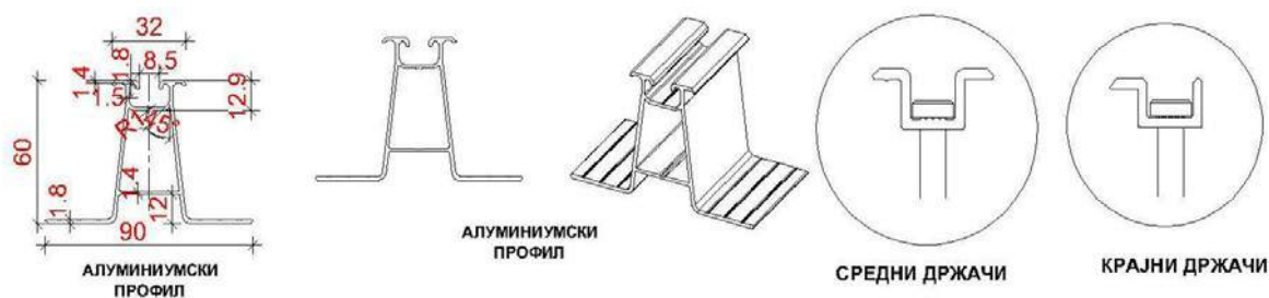
Слика 3 Изглед на алуминиумска потконструкција
