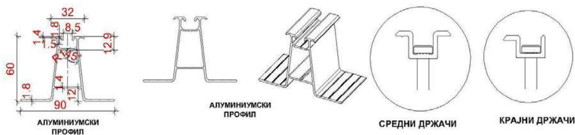
Слика 3 Изглед на алуминиумска потконструкција
