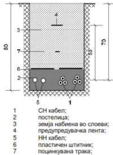
Слика 1. Полагање на кабли во ров на регулирана и нерегулирана површина
