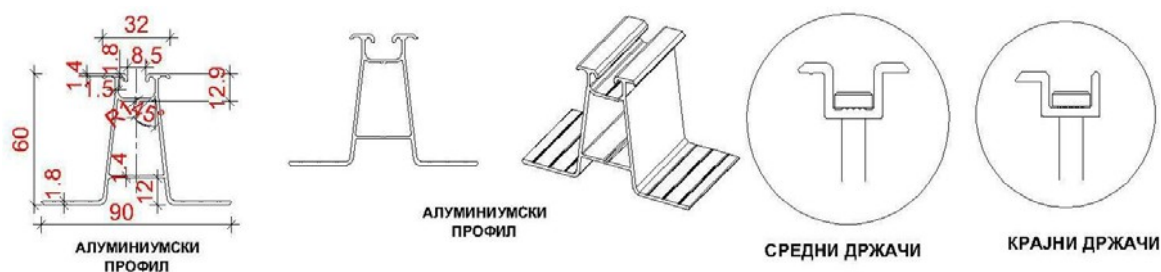
Слика 3 Изглед на алуминиумска потконструкција
